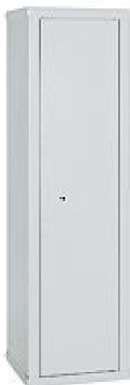
Composto da una struttura esterna monoblocco in acciaio di spessore 2 mm. Porta, sempre in acciaio, di spessore 2 mm. Catenacci di chiusura in acciaio cromato n° 3 Ø 22 mm e n° 2 Ø 18, azionati da una serratura tridirezionale a 6 lamelle con chiave a doppia mappa, astrabile solamente a chiusura effettuata.
